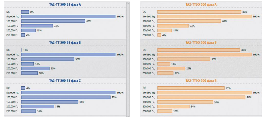
Рис.4 Гармонический состав электромагнитных ТТ (синий цвет) и оптических ТТ (желтый цвет) в момент времени равный 400 мс
