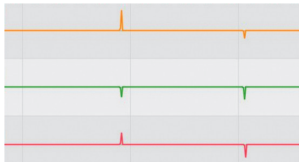
Рис. 10. Характер искажения измерений тока от ТТЭ0
