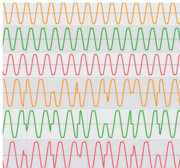
Рис. 11. Характер искажения измерения напряжения от ДНЭЭ
