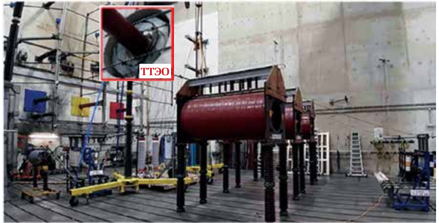
Рис. 10. Проведение испытаний на однофазное КЗ (КЕМА)
